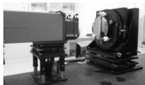
图 5 子孔径拼接检测设备图
