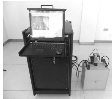
图 3 红外热波检测系统
