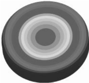
图 5 通光口径 \Phi 150 mm 光窗组件光学玻璃变形云图
