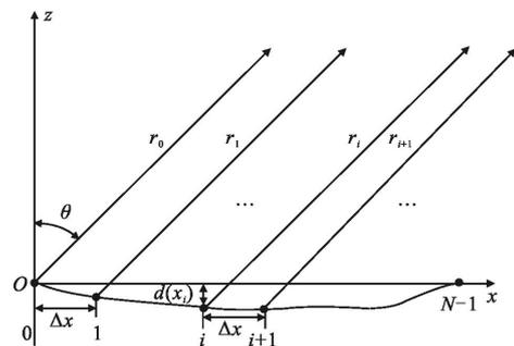
图 2  $N$  单元相控阵模型
