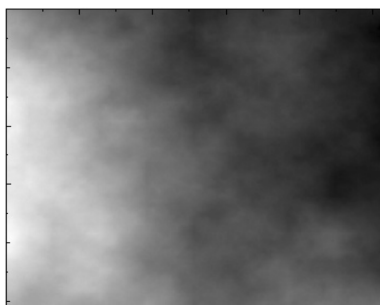
图 3 分形法模拟的谱幂率为 3.9 时的非 Kolmogorov 湍流相位屏 Fig.3 Non-Kolmogorov turbulence phase screen created by Fractal
