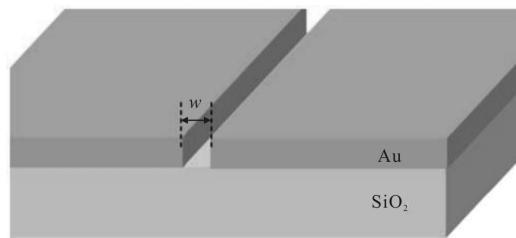
图 3 在金膜上刻蚀的槽型波导
