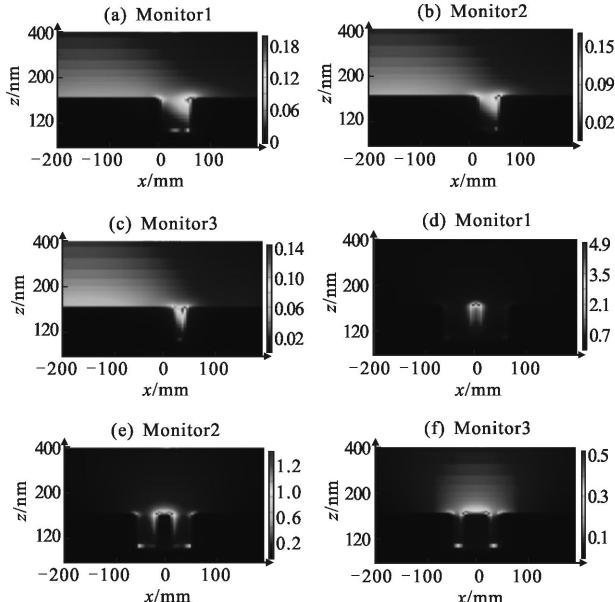
图6 3个监视器上的表面等离激元强度模拟结果
