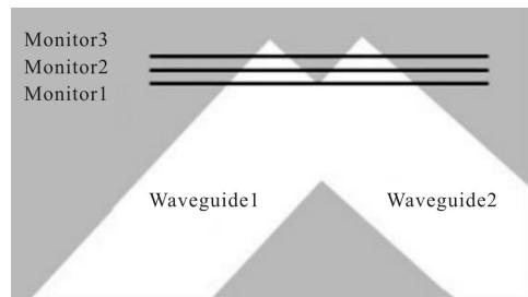
图5 输出端3个监视器位置示意图
