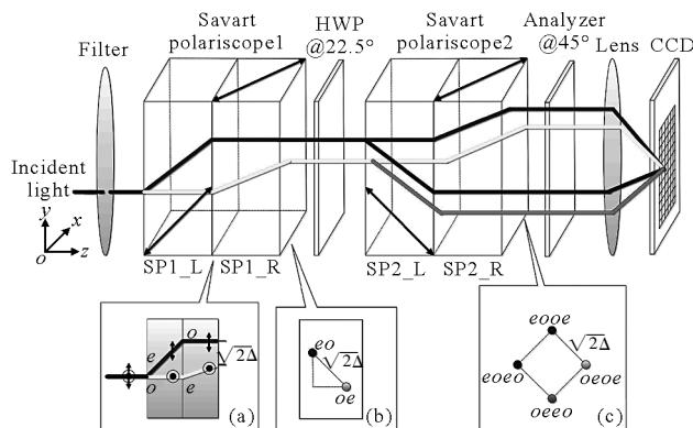
图1 空间调制型全偏振成像系统原理图
