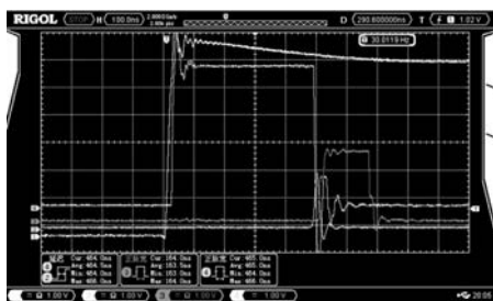
图 11 脉冲筛选电路板各信号通道波形
