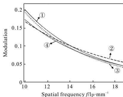
(c) 像管 4 个方向的 MTF 曲线
