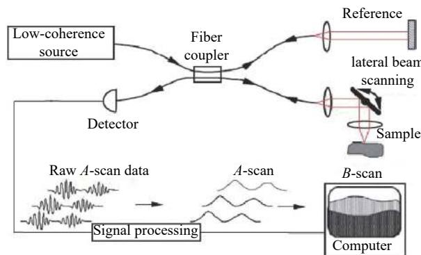
图 1 以光纤为基础构建的 OCT 系统<sup>[6]</sup>
