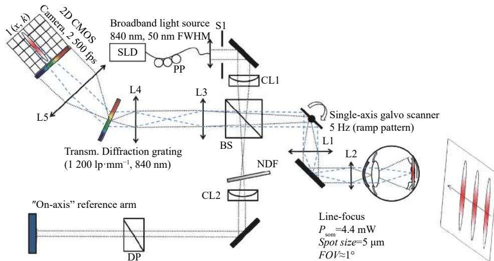
图 3 线场光谱域 OCT 的原理图<sup>[39]</sup>
