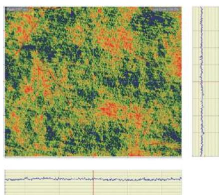
图 12 主反射镜光学表面粗糙度检测结果
