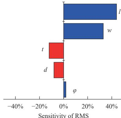
图 7 柔性两脚架参数对面形误差影响的敏感性分析
