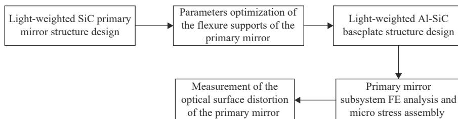
图 2 碳化硅主反射镜组件研制流程
