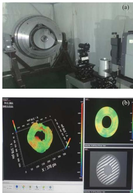
图 14 (a) 主反射镜装配后面形测量;(b)ZYGO 干涉仪面形测量结果
