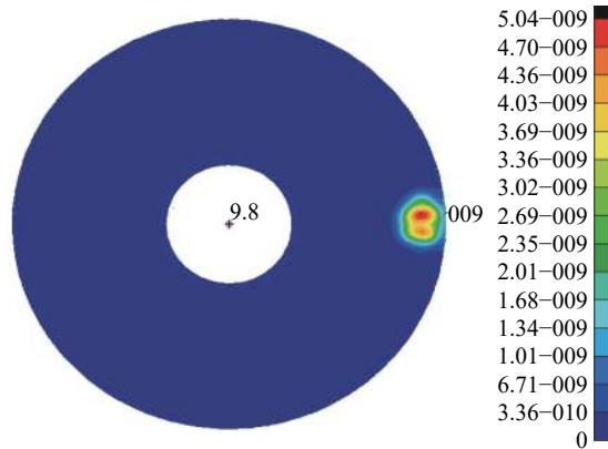
图 4 碳化硅主反射镜边缘加工最大变形
