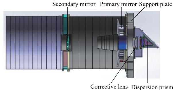
图 1 VT 望远镜系统光学结构图
