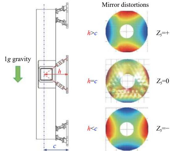
图 9 两脚架中心与反射镜质心之间的关系对反射镜面形的影响
