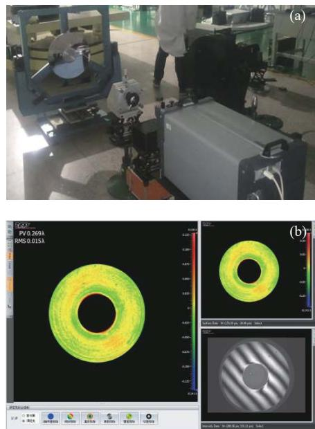
图 13 (a) 主反射镜装配前面形测量;(b)ZYGO 干涉仪面形测量结果
