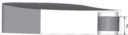
图 6 支撑结构安装深度
