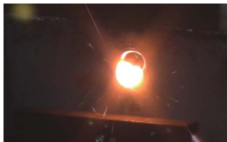
图 14 钢板被激光烧穿
