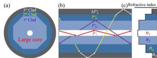
图 1 LMA-YTF 的 (a) 结构, (b) 传输光束和 (c) 折射率分布示意图
