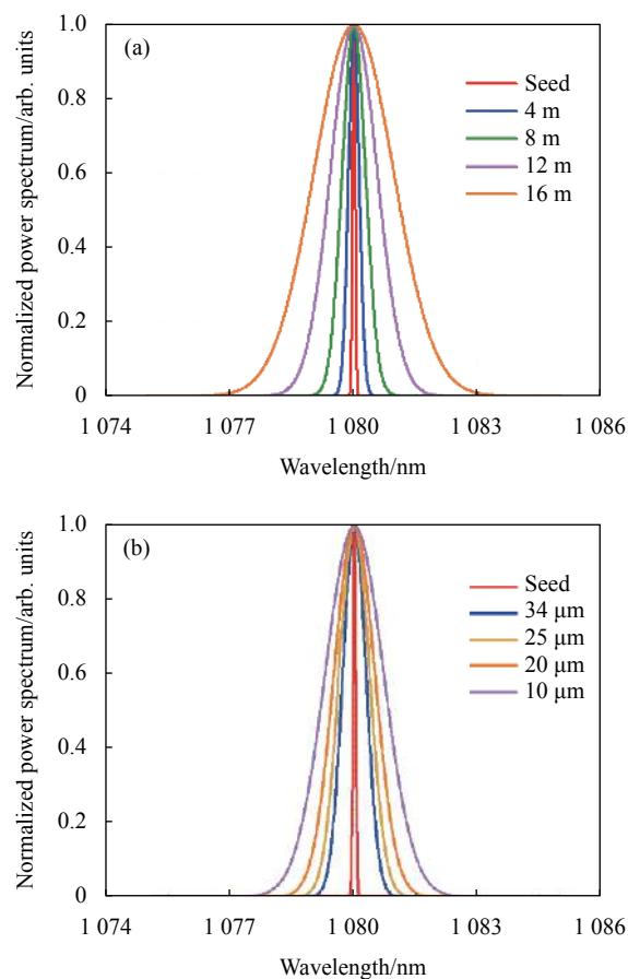
图 2 输出光谱随 (a) 放大器增益光纤长度和 (b) 纤芯直径变化曲线
