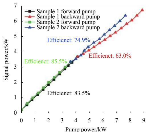
图8 国产化高功率窄线宽三包层光纤激光器的输出功率特性
