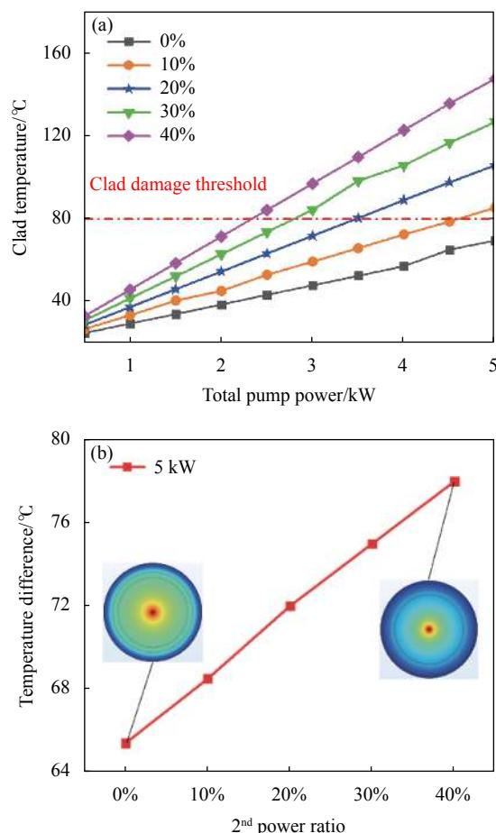
图3 (a) 聚合物涂层温度随反向泵浦功率的变化曲线和(b)总泵浦功率为5 kW时,纤芯与聚合物涂层温差曲线
