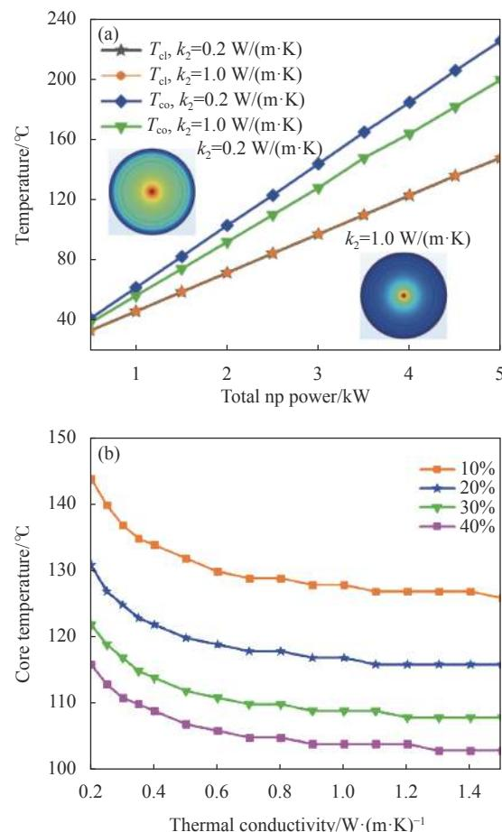
图4 (a) 不同导热系数纤芯和聚合物涂层温度随后向泵浦功率变化的曲线;(b)纤芯温度随导热系数变化曲线
