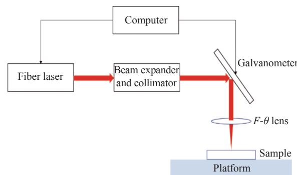
图 1 激光除锈系统结构示意图
