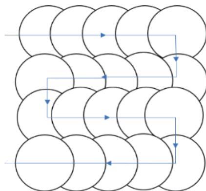
图 2 激光除锈过程中光斑扫描运动轨迹示意图
