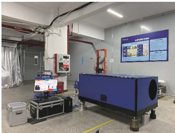
图 12 快反镜面形测试系统图
