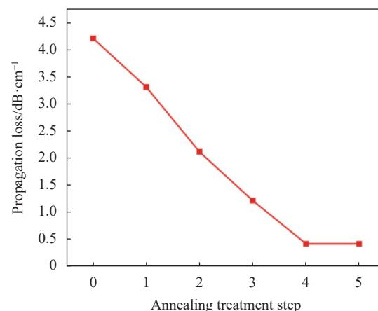
图 5 MgF<sub>2</sub> 脊形光波导传输损耗随热退火处理变化关系
