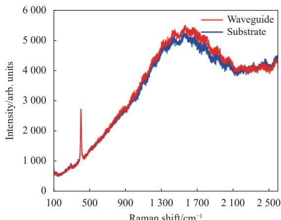
图 6 MgF<sub>2</sub> 晶体材料波导层和衬底层的拉曼光谱
