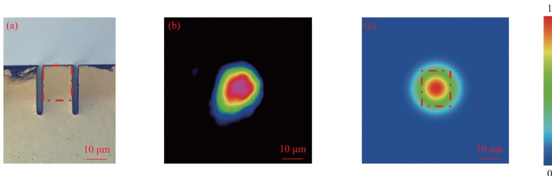
图 4 (a) 脊形光波导横截面显微镜图像;(b) 脊形光波导 4 μm 波长下近场模式分布实验图;(c) 脊形光波导 4 μm 波长下近场模式分布模拟图
