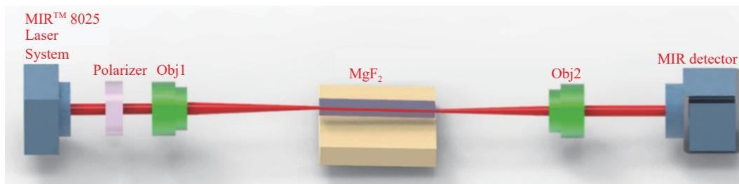
图 2 光波导端面耦合系统示意图
