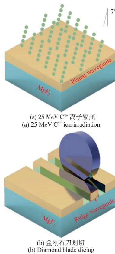
图 1  $\text{MgF}_2$  脊形光波导的制备过程示意图
