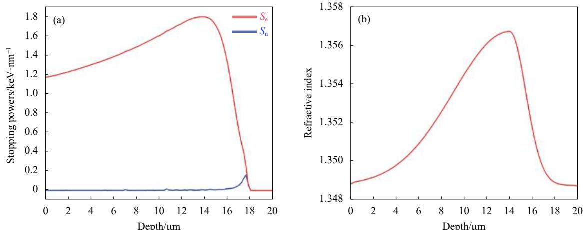
图 3 (a) 电子能量损伤 (红线) 和原子核能量损伤 (蓝线) 随  $\text{C}^{5+}$  离子辐照深度变化关系; (b) 重建的  $4 \mu\text{m}$  波长下  $\text{MgF}_2$  脊形光波导的折射率随波导深度变化关系图
