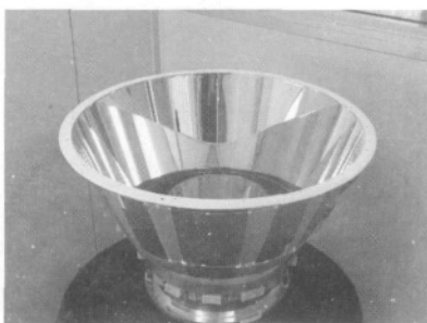
图 4 FY-2 卫星 O 型辐射制冷器
