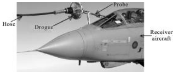
图1 软管式加油系统示意图 [2]
