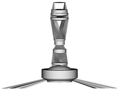
图 7 全景成像仪三维光路图
