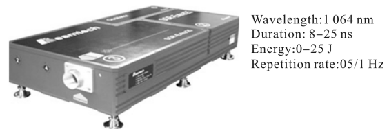
图 1 试验所用 YAG 激光器及其性能参数
