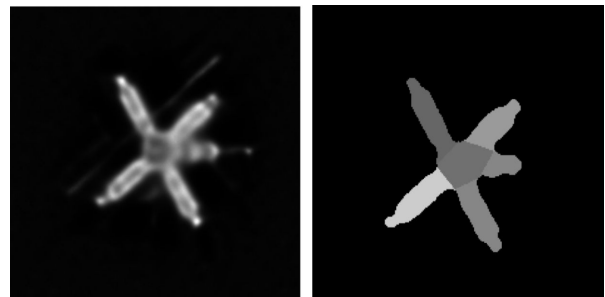
(a) 海事卫星模型图像 (b) 海事卫星模型图像形状分解 (a) Maritime satellite image (b) Decomposition result
