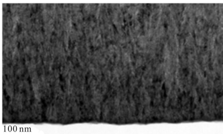
图 3 厚度为 500 nm 的 \text{HfO}_2 薄膜的扫描电镜图
