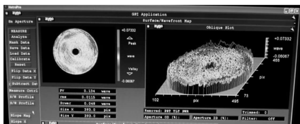
图 8 主镜面形误差检测结果
