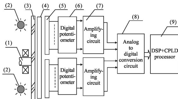
图 1 高精度编码器改进的结构原理框图
