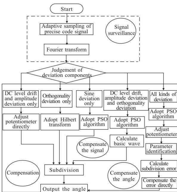
图 3 自动补偿系统的软件算法框图
