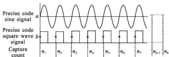
图 2 系统自适应采样原理
