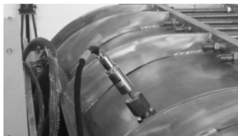
图 5 温度传感器安装位置图
