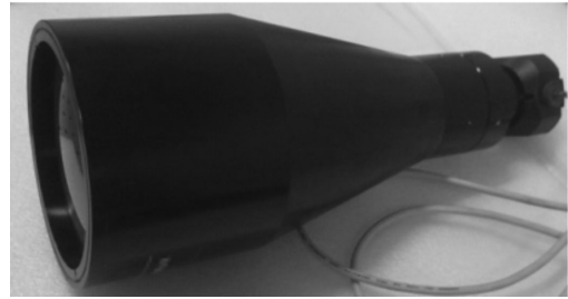
图 10 物镜样机实物图
