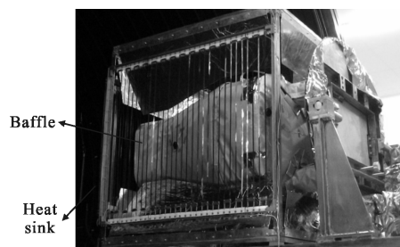
图 9 相机热平衡试验
