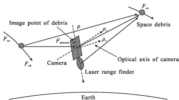
图 1 相对测量几何模型示意图
