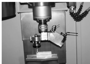
图 5 加工中心在机三维检测系统
