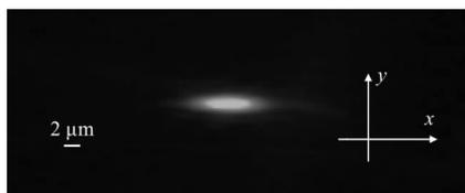
图 5 波长 1 550 nm 下 Er:Ta<sub>2</sub>O<sub>5</sub> 脊形波导近场模式
