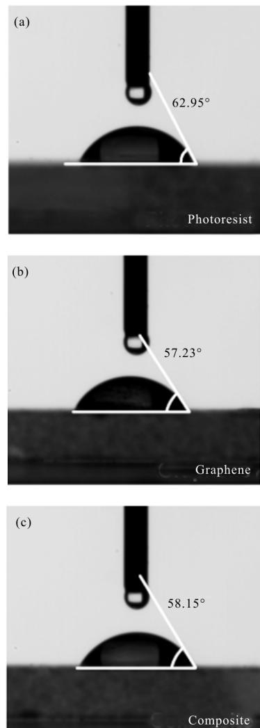
图 4 不同材料亲水角照片
