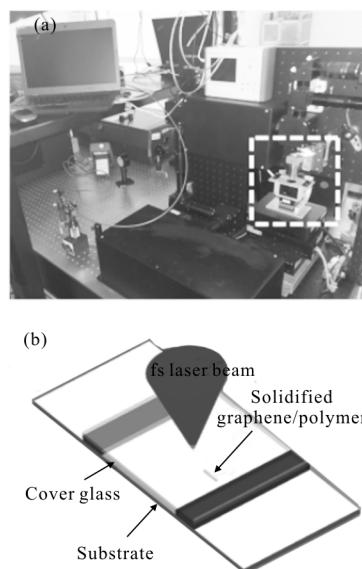
图 2 双光子聚合加工实验装置
