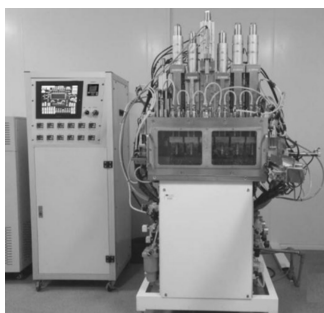
图 1 PFLF7-60A 型模压成型机床
