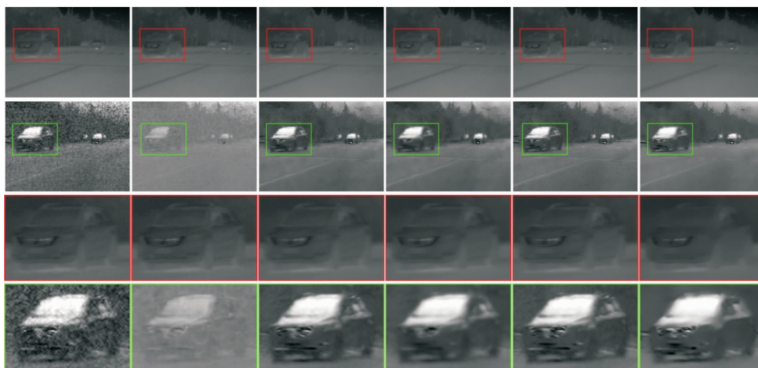
(a) 原始噪声图像 (b) PBM3D 算法 (c) PCA 算法 (d) PCA-rn 算法 (e) 文中 VPCA 算法 (f) 文中 VPCA-rn 算法 (a) Original noisy images (b) PBM3D (c) PCA (d) PCA-rn (e) Proposed VPCA (f) Proposed VPCA-rn
