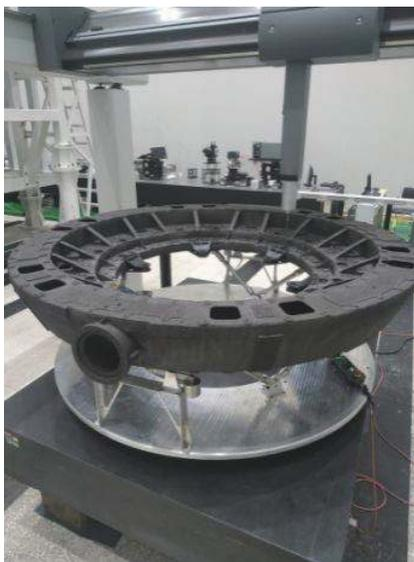
图 10 主承力板三坐标测试
