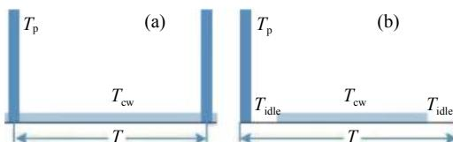
图 13 光脉冲序列。(a) $\Phi$ -OTDR 与 MZI 复用采用的光脉冲<sup>[33]</sup>; (b) $\Phi$ -OTDR 与偏振分集系统复用采用的光脉冲<sup>[33-34]</sup>
