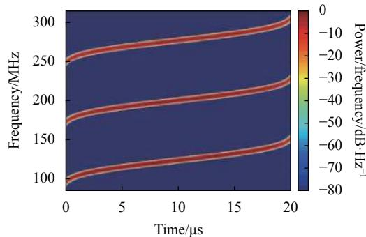
图 11 多频非线性频率调制脉冲频谱图<sup>[28]</sup>Fig.11 Spectrum of NLFM optical pulse<sup>[28]</sup>
