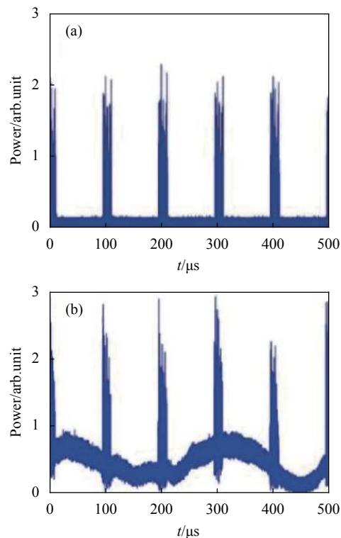
图 7 1.5 km 传感光纤下瑞利散射曲线。(a) 高消光比光脉冲; (b) 直接调制光脉冲<sup>[16]</sup>Fig.7 Rayleigh backscattering traces of 1.5 km FUT. (a) High extinction-ratio pulse; (b) Direct-modulation pulses<sup>[16]</sup>
