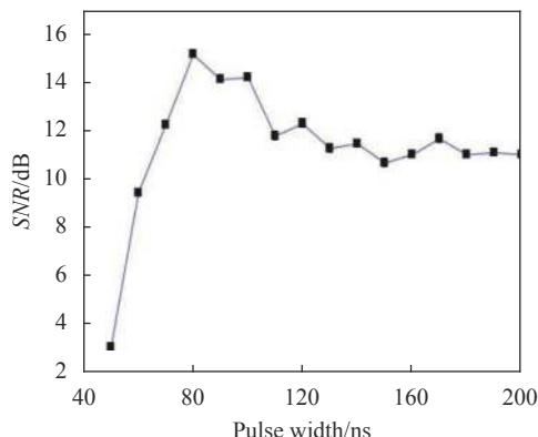
图 3 信噪比随脉冲宽度变化规律<sup>[10]</sup>Fig.3 Law of signal to noise ratio vs pulse width<sup>[10]</sup>
