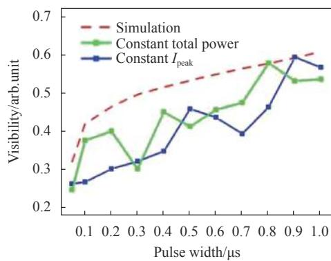
图 2 不同脉冲宽度下系统的干涉可见度<sup>[9]</sup>Fig.2 Interference visibility of the system at different pulse widths<sup>[9]</sup>
