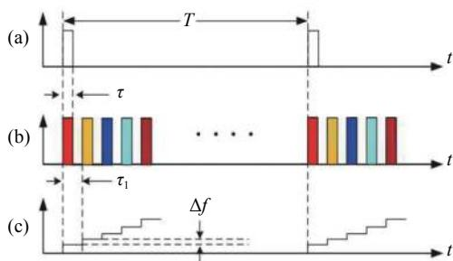
图 14 (a) 传统 $\Phi$ -OTDR 中的脉冲序列;(b) 频分复用 $\Phi$ -OTDR 中的脉冲序列;(c) 脉冲序列的频率变化<sup>[35]</sup>
