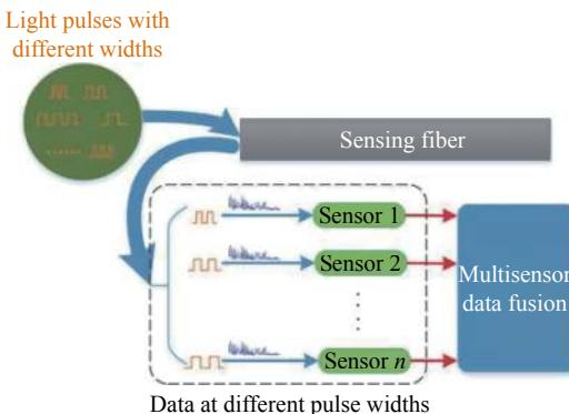
图 8 脉宽复用原理图<sup>[21]</sup>
