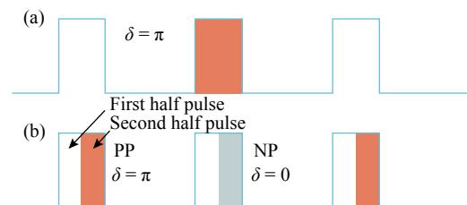
图 9 0- $\pi$  二进制相移光脉冲。(a) 相移双脉冲法<sup>[24]</sup>; (b) 差分相移脉冲法<sup>[25]</sup>
