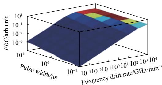
图 5 不同频率漂移和脉冲宽度下的波动率系数<sup>[12]</sup>Fig.5 FRC of different frequency drift rates and pulse widths<sup>[12]</sup>
