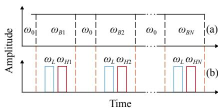
图 16 频分复用的双脉冲。(a) 可调激光光源调制; (b) 声光调制器调制<sup>[44]</sup>
