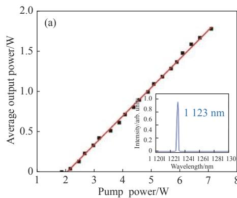
图 4 Nd:YAG 激光器在 (a) 连续运转和 (b) 调 Q 时输出功率与泵浦功率的关系曲线, 插图为输出光谱
