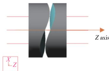
图 1 自由曲面透镜组模型
