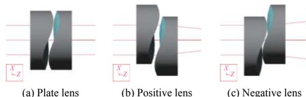
图 2 相对偏移量  $\delta$  对透镜的影响
