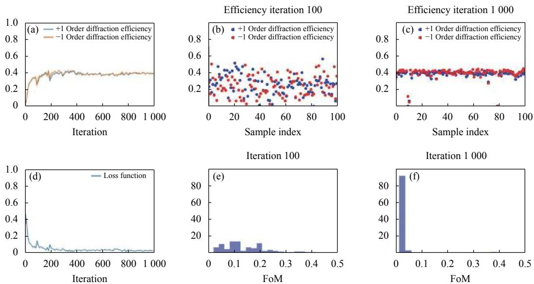
图 2 偏折角为 150° 的超构光栅分束器对应的衍射效率和目标函数值。(a)、(d) 超构光栅分束器平均衍射效率和平均目标函数值随训练次数的变化;
