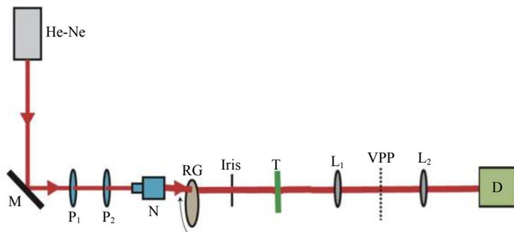
(a) 传统的 4f 系统傅里叶频谱滤波成像系统示意图
