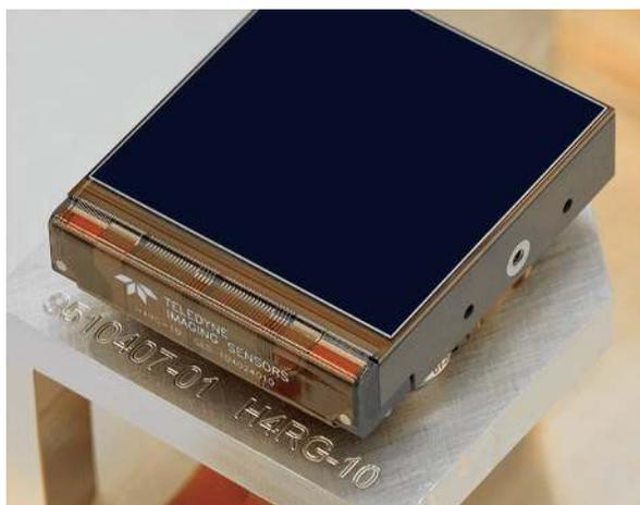
图 8 H4 RG 4 096×4 096 HgCdTe 焦平面阵列组件<sup>[8]</sup>
