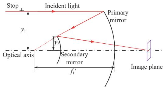
图 3 同轴两反射镜光学系统
