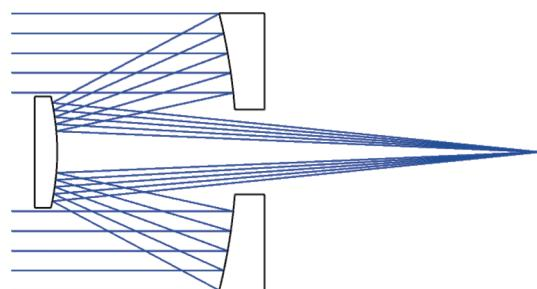
图 4 同轴两反光学系统初始系统布局图
