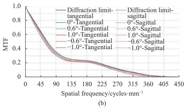
图 5  $2^\circ$  视场包含两片校正镜的折反光学系统。(a) 布局图;(b) MTF 图
