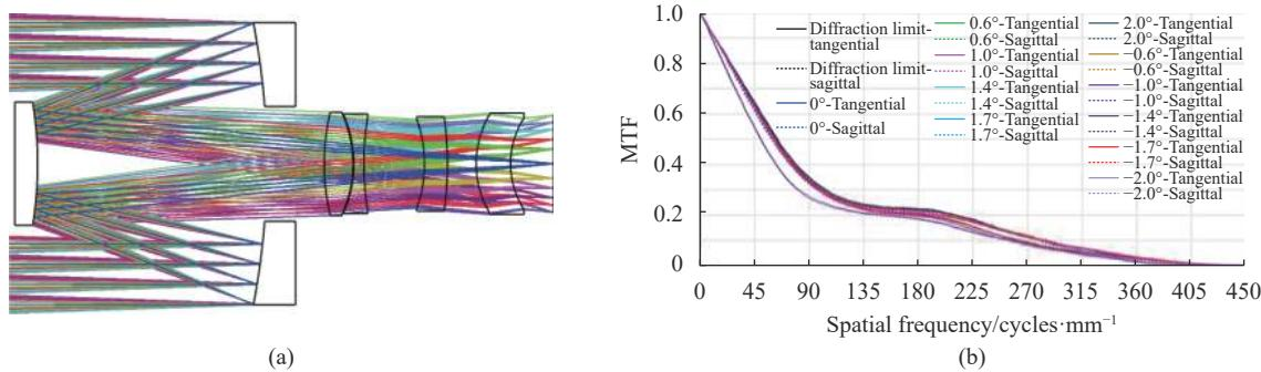
图 6 4°视场包含四片校正镜的折反光学系统。(a) 布局图; (b) MTF 图
