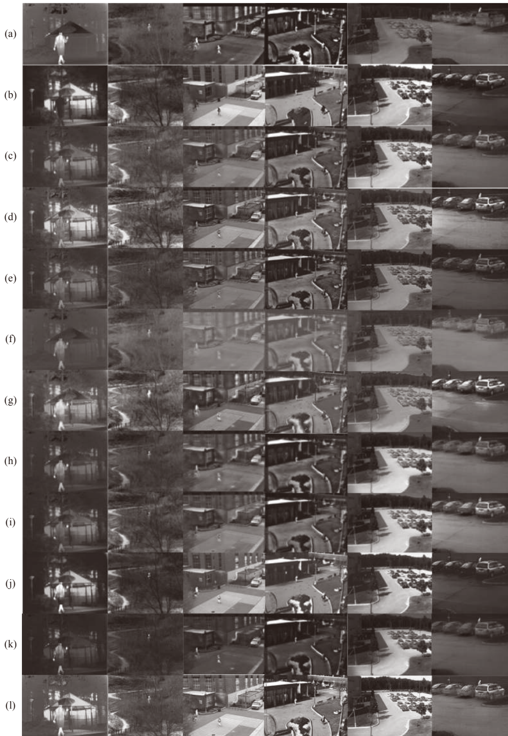
图 8 定性融合结果。(a)、(b) 红外、可见光图像；(c)~(l) DenseFuse、FusionDN、U2 Fusion、FusionGAN、DDcGAN、GANMcC、RFN-Nest、STDFusionNet、SDDGAN 以及 SeAFusion 方法融合结果
