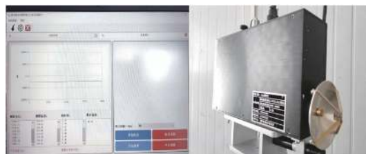
图 1 3 mm 被动毫米波辐射计与操作界面图
