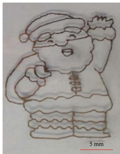
图 4 在玻璃基底上打印出的带断续点复杂图案 (图中比例尺为 5\ \text{mm} )
