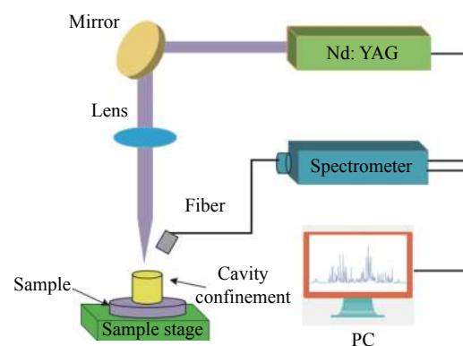
图 1 LIBS 实验装置图
