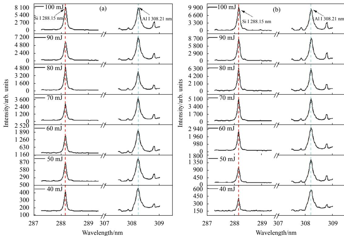
图 5 Al、Si 元素在两种 LIBS 条件下光谱强度随激光能量变化图。(a) LIBS; (b) CC-LIBS
