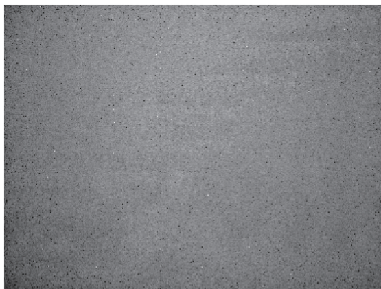
图 16 长波 384×288 数字像元探测器原始输出图像
