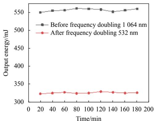
图 7 激光输出能量稳定性测试
