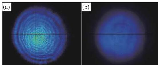
图 9 激光光斑图: (a) 整形前激光光斑图; (b) 整形后脉冲激光光斑
