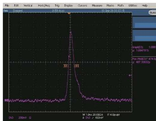
图2 种子源输出脉冲激光波形图
