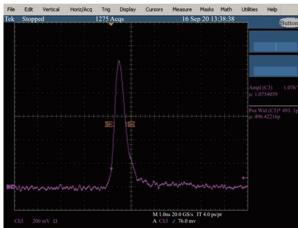
图 8 放大激光脉宽波形图
