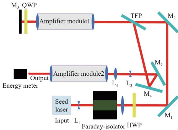
图 3 激光放大器装置示意图 (L<sub>1</sub> 为凹透镜, L<sub>2</sub> 为凸透镜, FI 为法拉第隔离器, HWP 为半波片, M<sub>1</sub>、M<sub>2</sub> 为 45°反射镜, TFP 为薄膜偏振片, AM1 为一级放大模块, QWP 为四分之一波片, M<sub>3</sub> 为全反射镜, M<sub>4</sub>、M<sub>5</sub> 为 30°反射镜, L<sub>3</sub> 为凹透镜, L<sub>4</sub> 为凸透镜, AM2 为二级放大模块)
