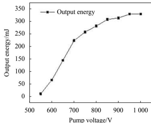
图 6 532 nm 输出能量随泵浦电压关系图
