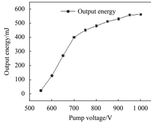
图 5 输出能量随泵浦电压关系图
