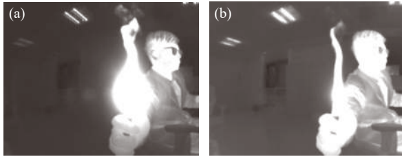
图 3 打火机点燃后对比试验图。(a) 中波;(b) 长波
