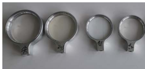
图 9 试验使用不同材料窗口(从左至右依次为:尖晶石、硫化锌、氧化锆、氧化钇)
