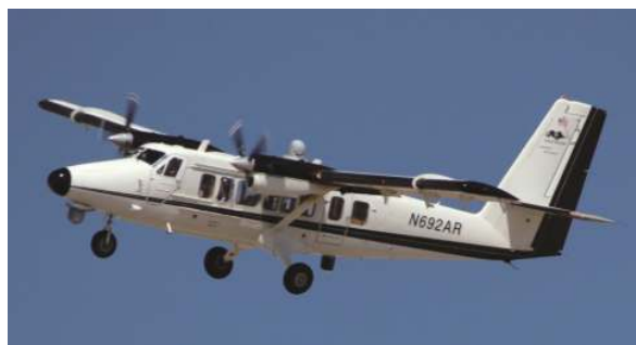
图 5 FOENEX 链路空基节点,有 2 套激光终端,分别在机翼和机鼻处各安装了 1 套)
